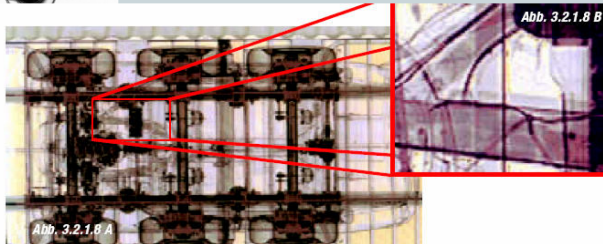
Abb. 3.2.1.8: Nachweis von 19 kg Kokain (Wert ca. 3 Millionen €) in der Karosserie des Oldtimers von Abb. 3.2.1.7. In der vertikalen Sicht (A) und durch Detailvergrößerung (B) zeigen sich die Drogenpäckchen. Containerprüfanlage Hamburger Hafen (1997).
